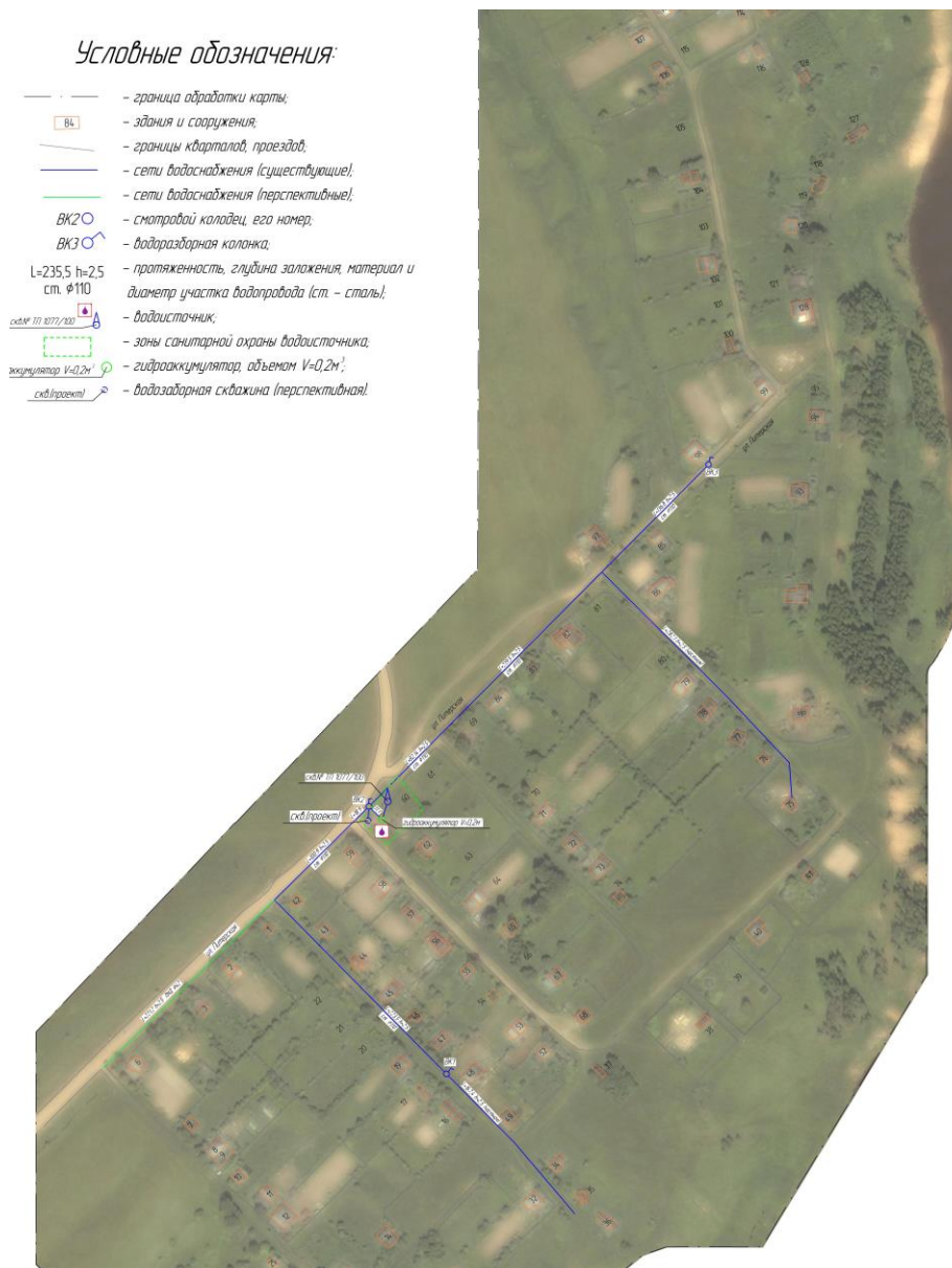
Рис.8. Карта расположения объектов системы водоснабжения в д. Городище технологическая зона Пожвинская
